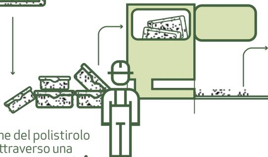
Lavorazione del polistirolo espanso attraverso una **macchina pressatrice e compattatrice**
